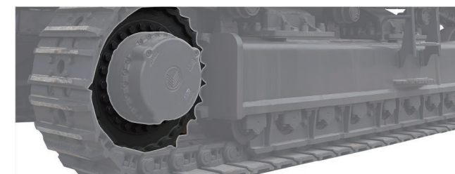
重载链轮 重载链轮进一步延长整机的耐久性。
